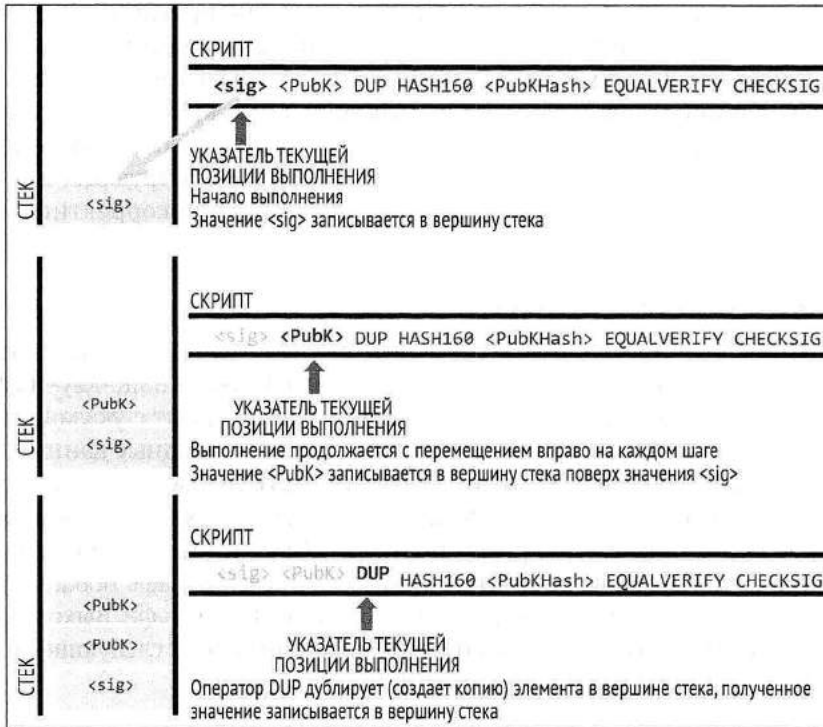
Рис. 6.5 ❖ Выполнение скрипта для транзакции типа P2PKH (часть 1 из 2)
