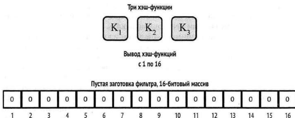
Рис. 8.8 ❖ Пример упрощенного фильтра Блума с 16-битовым массивом и тремя хэш-функциями
