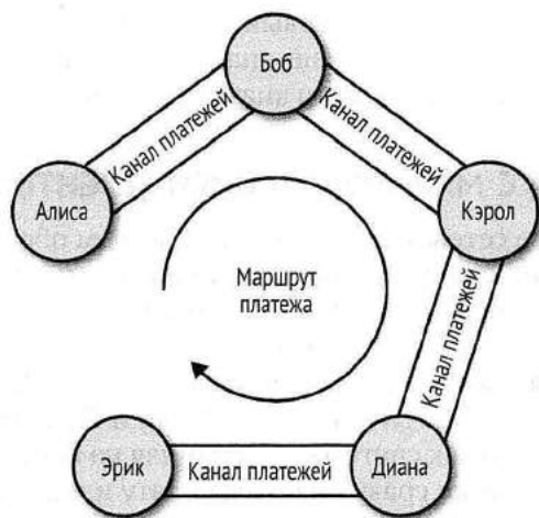
Рис. 12.9 ❖ Последовательность двунаправленных каналов платежей, связанных в сеть Lightning Network, которая может обеспечить маршрутизацию платежа от Алисы к Эрику
