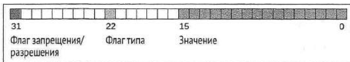
Рис. 7.1 ❖ Схема битовой структуры значения nSequence (источник: BIP-68)
